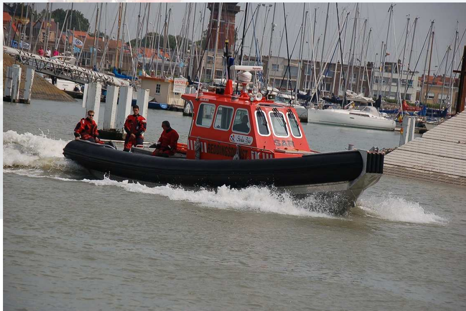
De reddingsboot Sterken Dries aangedreven door 2 Catterpillar-motoren
